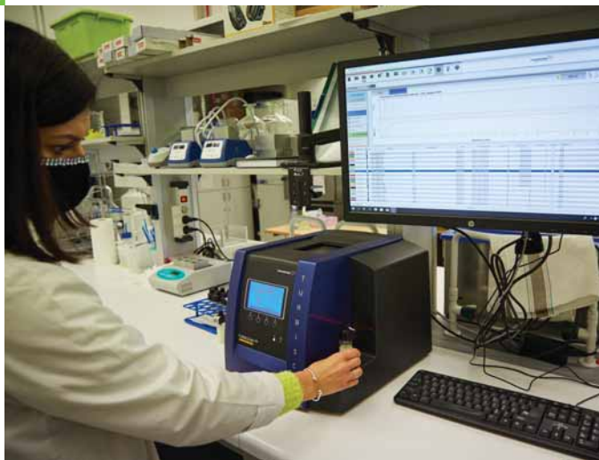
Badanie stabilności bazy emulsyjnej lodów mlecznych za pomocą turbiscanu
