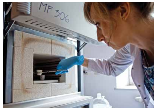
Mineralizacja próbek żywności w piecu muflowym
